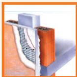
Isolamento termico con rivestimento a cappotto sp. cm. 10 e eliminazione di ponti termici.
